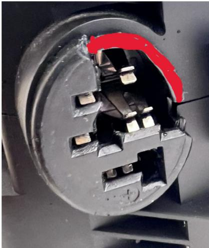
Danach am Ersatzdeckel innen entlang des Rades eine dünne Schicht Sekundenkleber auftragen und sofort auf die vorbereitete Buchse drücken für ca. 15 Sek. Die vollständige trockenzeit entnehmen Sie bitte der Anleitung des Klebers.
